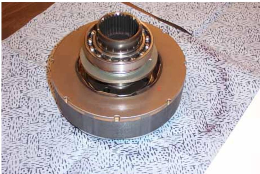
**Fig. 2.7. 2004 Prius generator rotor.**
