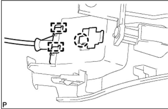
Libérer la griffe et les 2 guides, puis débrancher le câble de commande de verrouillage de capot.
