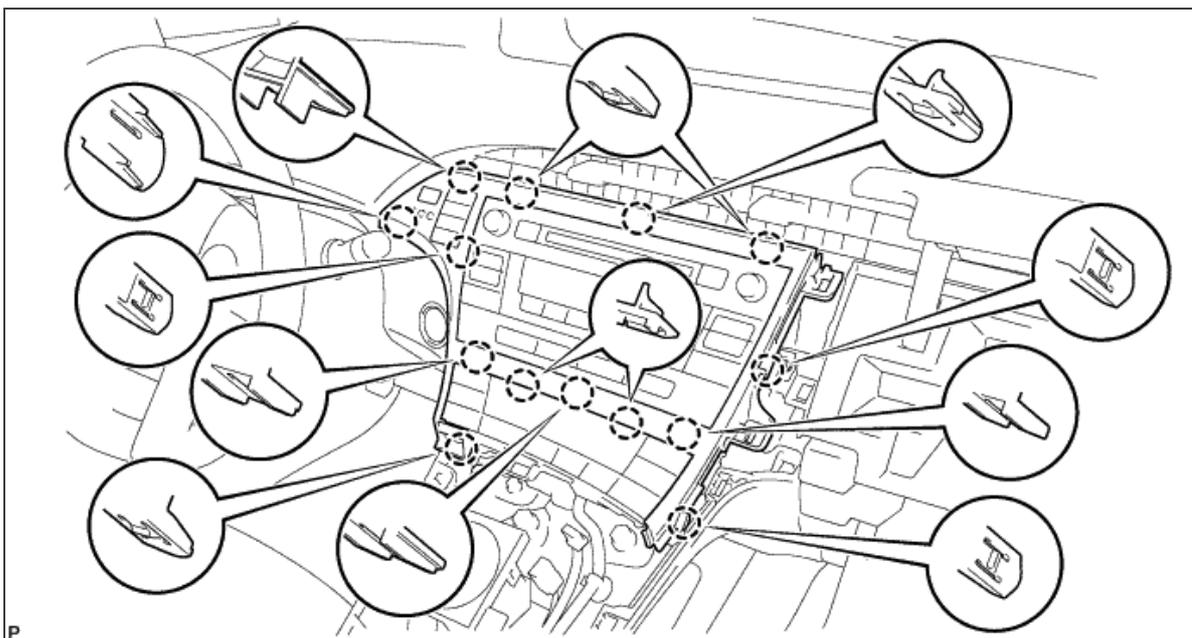
**10. DEPOSER LE SOUS-ENSEMBLE DE PANNEAU DE FINITION SUPERIEUR DE TABLEAU DE BORD**
