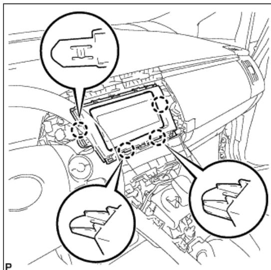
**12. DEPOSER LE CACHE D'OUVERTURE DE TUNER DE RADIO AVEC SUPPORT (sans autoradio)**
