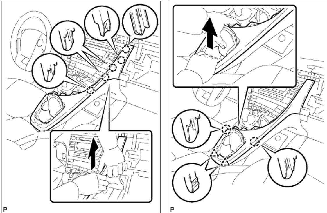
Tirer le sous-ensemble central de panneau de finition de combiné d'instruments inférieur dans le sens indiqué par la flèche pour libérer les 5 griffes et déposer le sous-ensemble central de panneau de finition de combiné d'instruments inférieur.
