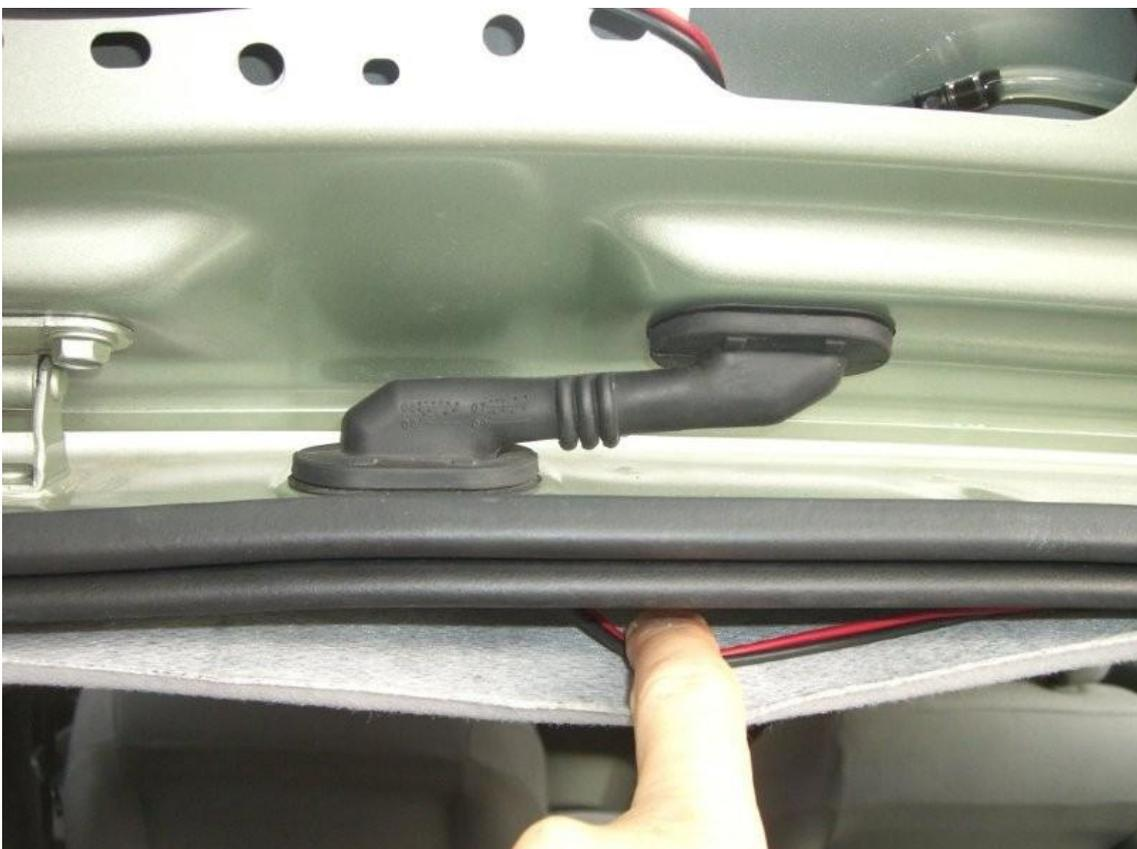
Deciros que el conector de la derecha ya incluye de fábrica una tirada de cable para la cámara. Yo no la utilizo porque no sé donde acaba (creo que en un lateral entre puertas o debajo de un asiento delantero).
