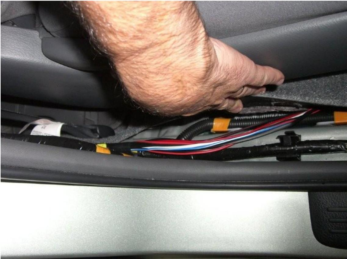
Ya en el MFD, en vez de comprar los espadines en el concesionario adapto unos de ordenador. En esta foto lo voy a hacer con el pin 29 del conector M14, SALIDA de tensión de 6 voltios para alimentar la cámara. Parece que esta cámara que he instalado sí funciona a 6v según
